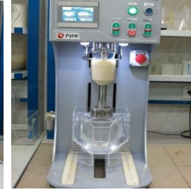
Лабораторная пневмо-механическая флотомашина РИФ-1,5 электронное управление, сьем пены осуществляется пеногоном
