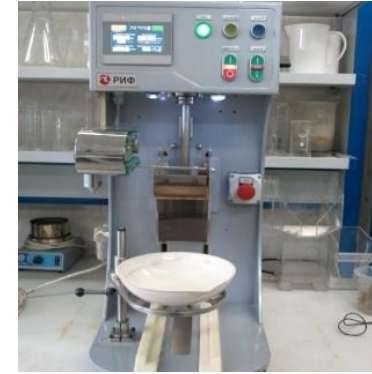
Лабораторная пневмо-механическая флотомашина РИФ-1,5 электронное управление, сьем пены осуществляется пеногоном
